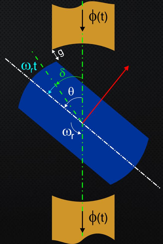
Para todos os efeitos, podemos considerar que a relutância do circuito magnético varia senoidalmente com a posição  $\theta$  do rotor entre um valor máximo e um valor mínimo, como mostra a figura.
